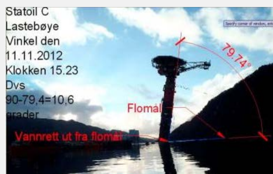
Abb. 18: 79.74°-Neigung der Ladeplattform Statfjord C
