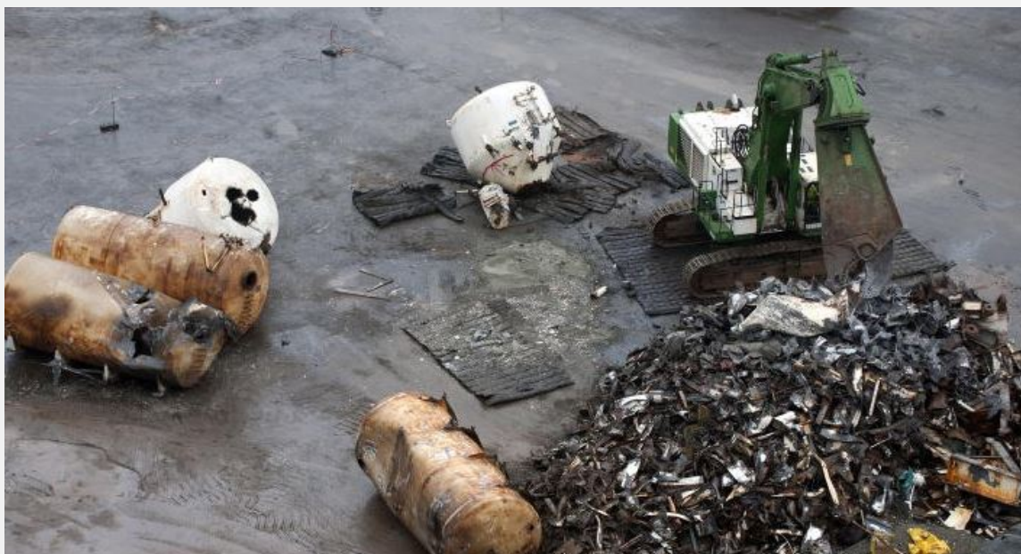
Abb. 1: Radlader mit aufmontierter „Trennschere“
